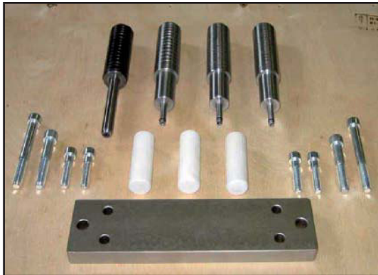
- ATR044. Attrezzatura montaggio/smontaggio fornito in dotazione alla pompa.
